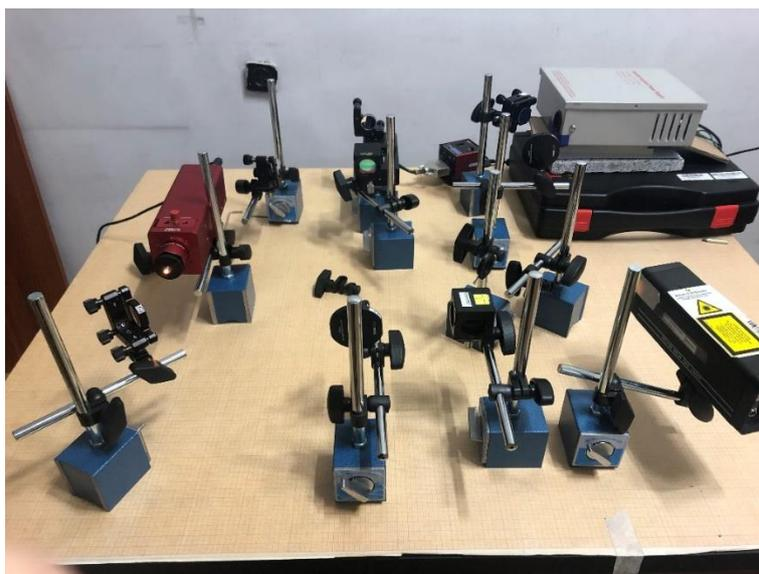
Зураг 42. FTIR спектрометрийн элементүүдийг ширээнд угсарсан байдал
