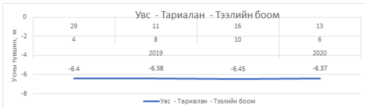
Зураг 3.1. Тээлийн боомд байрлах цооногийн усны түвшний хэмжилт
