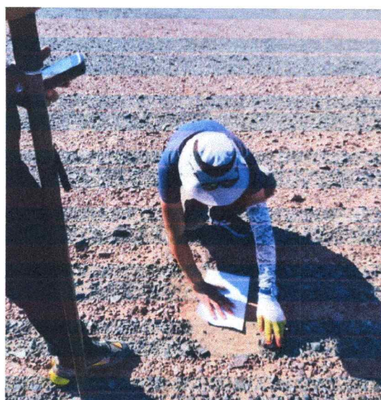
Зураг 3. Нислэгийн талбайд газрын хяналтын цэгийг тэмдэгжүүлж байгаа байдал
