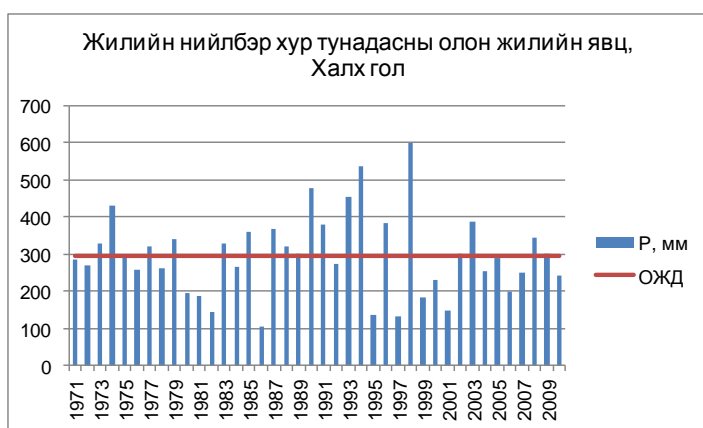
1.109 дүгээр зураг. Буйр нуур, Халх голын сав газрын жилийн нийлбэр хур тунадасны олон жилийн явц
