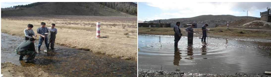
1.192 дугаар зураг. Сэлбэ голын ус судлалын харуулын чиглэл дэх усны өнгөрөлт хэмжлэг, 2014
