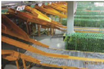
박스 소터 허브센터 내 각 층에서 출고된 박스들을 배송방면(지랑) 별로 자동분류하는 설비
