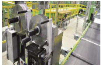
자동 라벨 부착기 출고된 박스에 배송매장 별 정보가 담긴 라벨을 자동으로 인쇄, 부착하는 장비
