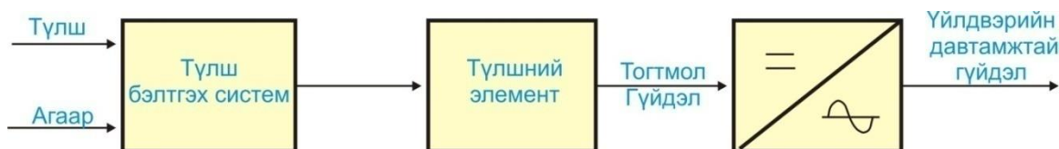
Зураг. 3.24. Түлшний элемент дээр үндэслэсэн цахилгаан станцын бүдүүвч
