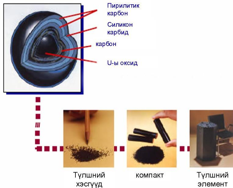
Зураг.3.12. GT-MHR реакторт ашиглах “TRISO” түлшний элементийн бүдүүвч
