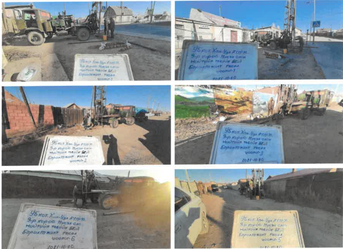
Зураг 4: Хээрийн судалгааны баг өрөмдлөг судалгаа болон цооногийн бичиглэл хийж ул хөрсний дээж авах ажил
