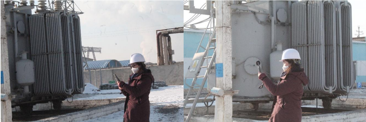
Зураг 16. СЕМ DT-8820 орчны хэмжилтийн багажаар хэмжиж буй байдал /Харьцангуй чийг, дуу чимээ/ Байгаль орчны төлөв байдлын судалгааны хүрээнд 2 цэг сонгож дуу чимээний хэмжилт хийсэн.
