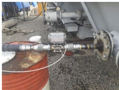
Зураг 2. Цэвэрлэх төхөөрөмжийн трансформаторт холбосон байдал
