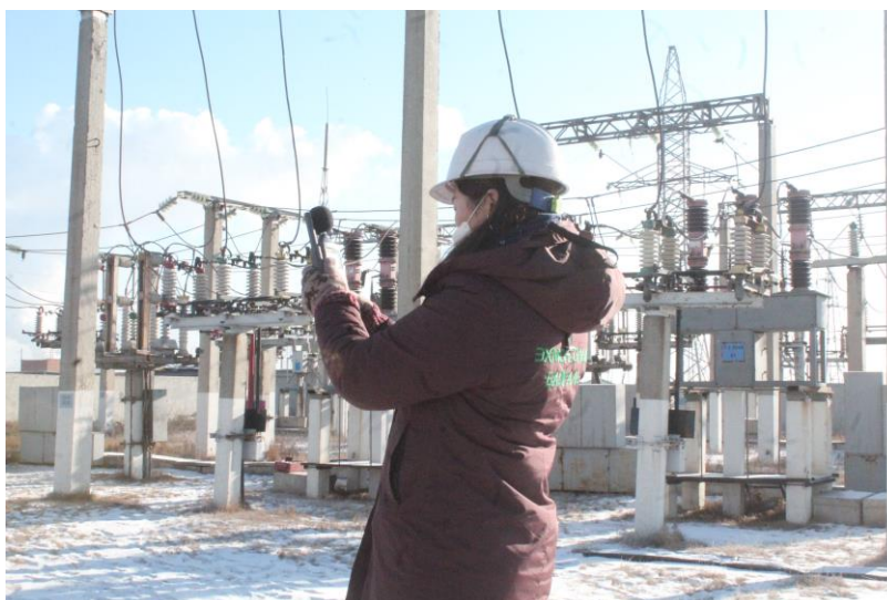
Зураг 16. SEM DT-8820 орчны хэмжилтийн багажаар хэмжиж буй байдал /Харьцангуй чийг, дуу чимээ/
