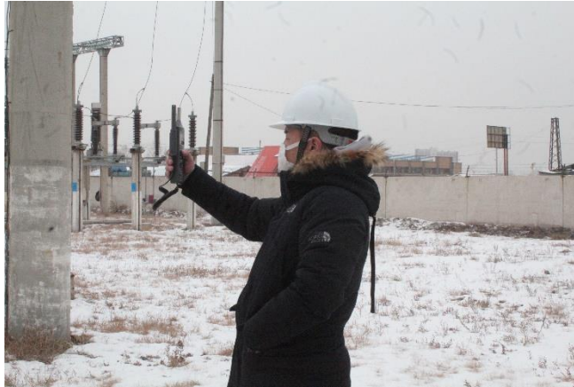
Зураг 17. СЕМ DT-8820 орчны хэмжилтийн багажаар хэмжиж буй байдал /Харьцангуй чийг, дуу чимээ/
