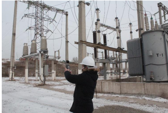
Зураг 16. СЕМ DT-8820 орчны хэмжилтийн багажаар хэмжиж буй байдал /Харьцангуй чийг, дуу чимээ/
