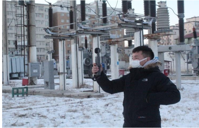
Зураг 14. СЕМ DT-8820 орчны хэмжилтийн багажаар хэмжиж буй байдал /Харьцангуй чийг, дуу чимээ/
