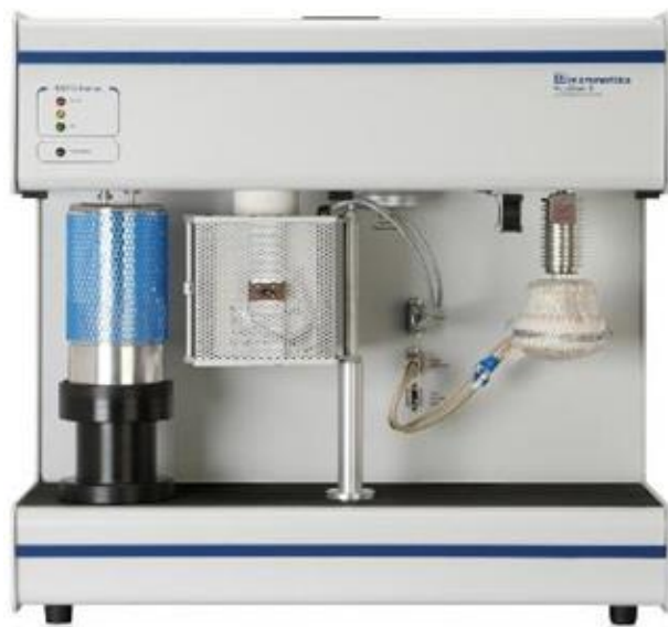
14-р зураг. Устөрөгчийн ангижруулалтын шинжилгээний AutochemII 2920 багаж
