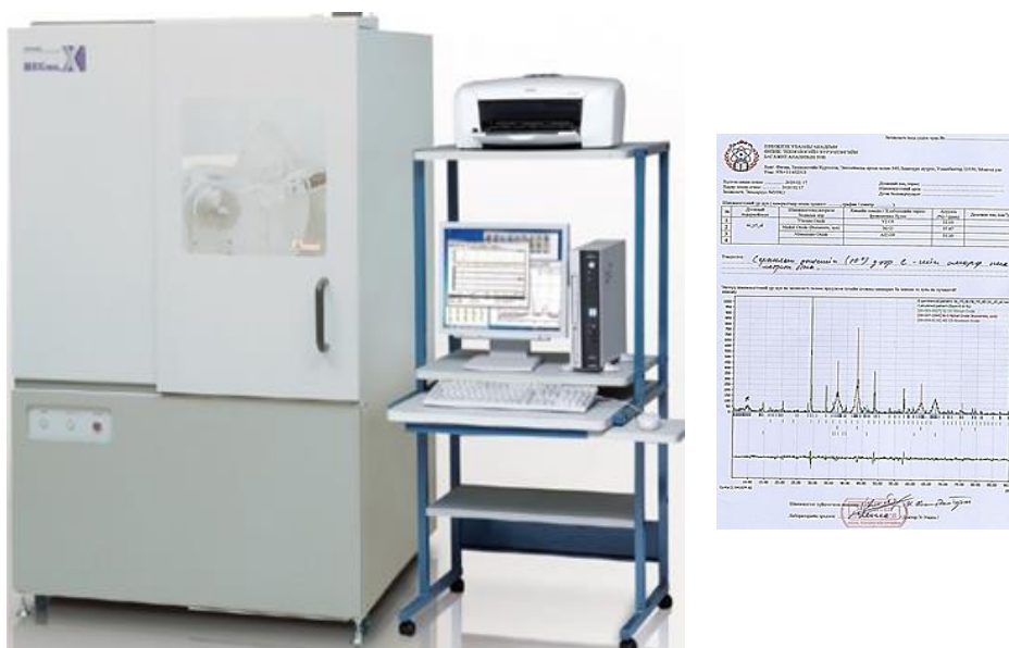
11-р зураг. Maxima-X XRD-7000 рентген дифракцын шинжилгээний багаж
