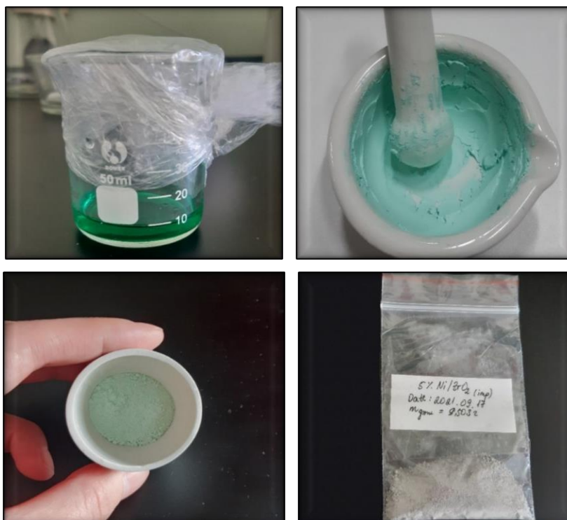
9-р зураг. Ni/ZrO 2 катализатор бэлтгэж буй байдал
