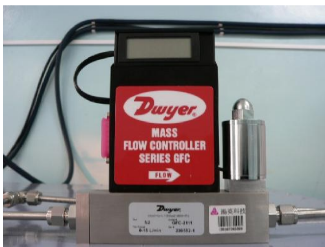
38-р зураг. Хийн урсгал хэмжигч автомат төхөөрөмж (massflow controller)
