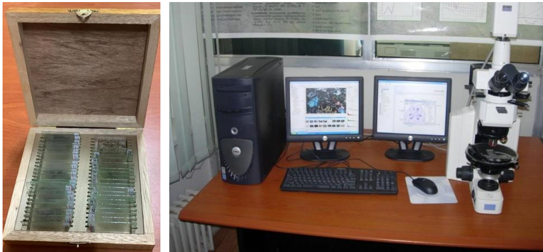
II.8-р зураг. Бэлтгэгдсэн шлиф, петрографийн судалгааны микроскоп
