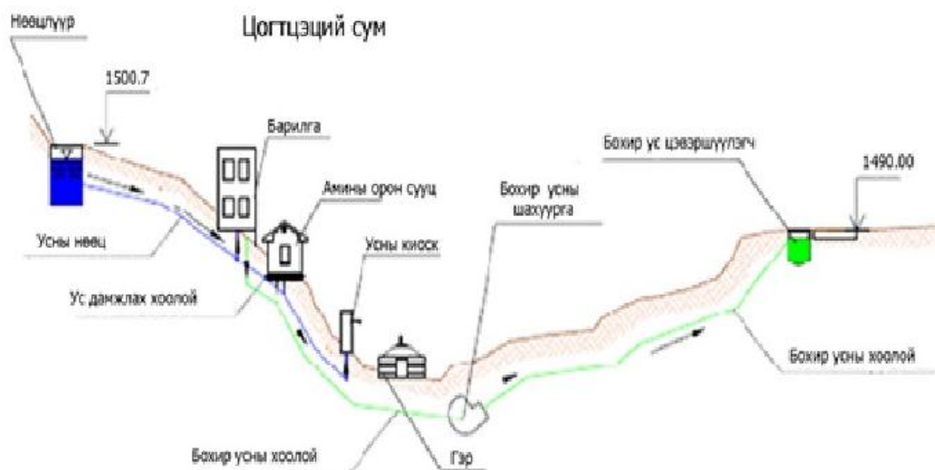
Схем зураг 12. “Монгидро Констракшн”-ы санал болгож буй ус хангамжийн систем
