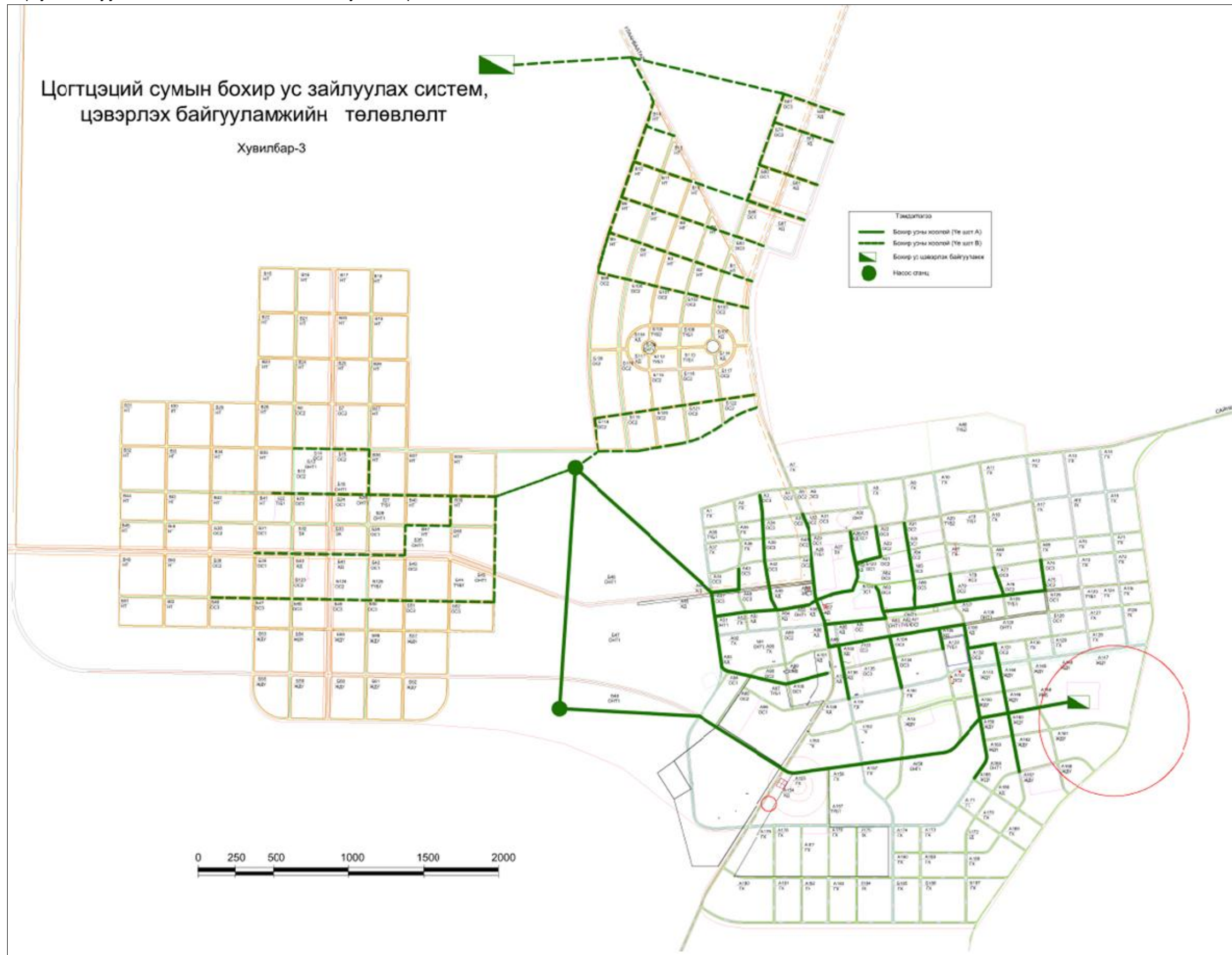
Схем зураг 15. Бохир ус зайлуулах системийн төлөвлөлт. Хувилбар-3.
