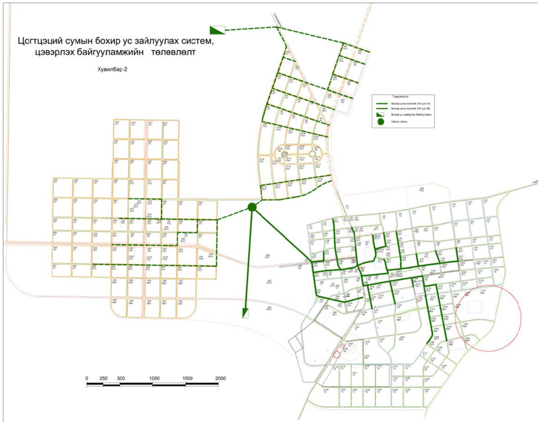
Схем зураг 14. Бохир ус зайлуулах системийн төлөвлөлт. Хувилбар-2.
