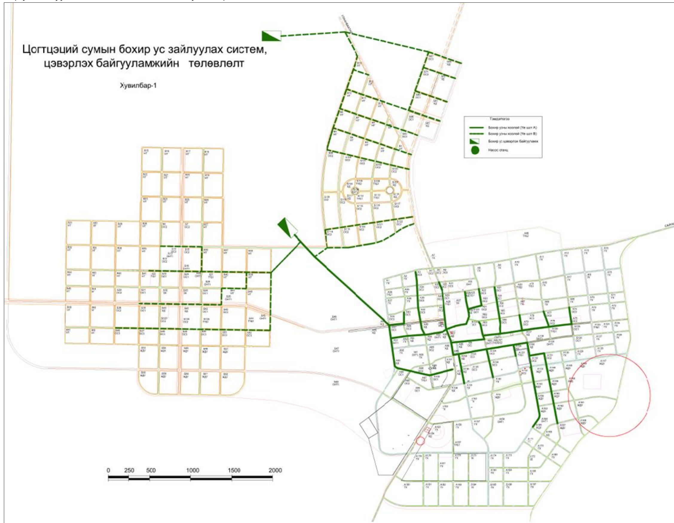
Схем зураг 13. Бохир ус зайлуулах системийн төлөвлөлт. Хувилбар-1.
