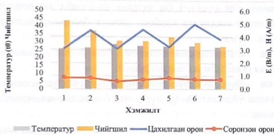
Зураг 1. Реле хамгаалалтын төхөөрөмжийн (SEL реле 11P) орчны ЦСО ба агаарын параметруудын хамаарал
