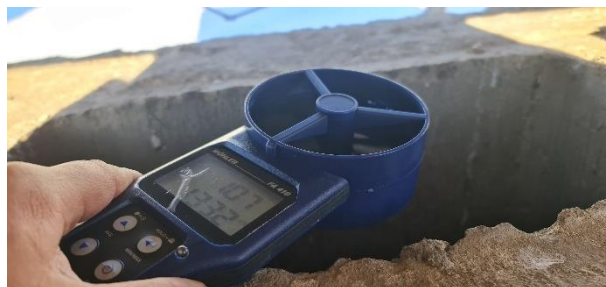
Зураг 21. Дээврийн агаар зайлуулах шахтын байдал болон агаарын зарцуулалтын хэмжилт
