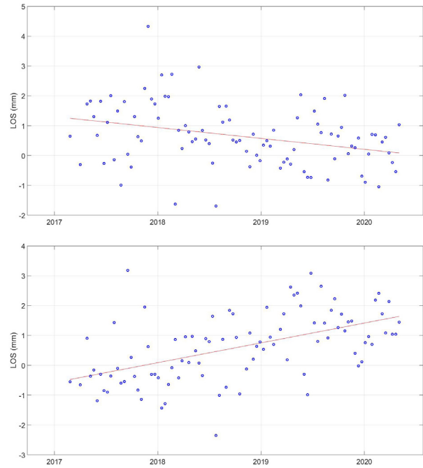
Зураг 14 Улаанбаатар орчмын гүүрэн болон өндөр барилгуудын хазайлтыг харьцуулсан байдал (а-зайсангийн гүүр, б-Кристалл таун барилгын А блок, в-120-ын гүүр, г-Яармагийн шинэ гүүр)
