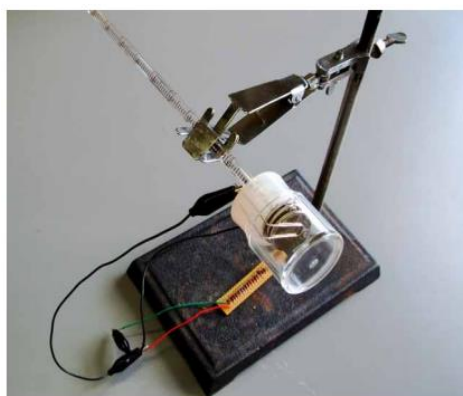
Зураг 1. Угсарсан туршилтын багаж (хувилбар 1: Японы судлаачдын туршилтлаа хэрэглэсэн)
