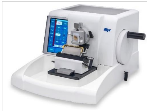
Зураг 5.5. Микрометрийн зузаантай мембраныг үхрийн туурайнаас гарган авах микротом
