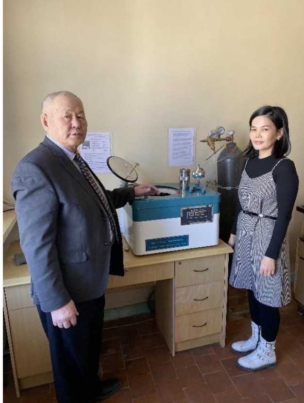
5.14 дүгээр зураг. Хатуу түлшний энергийн үзүүлэлтийг шалгах GDY-1C багаж
