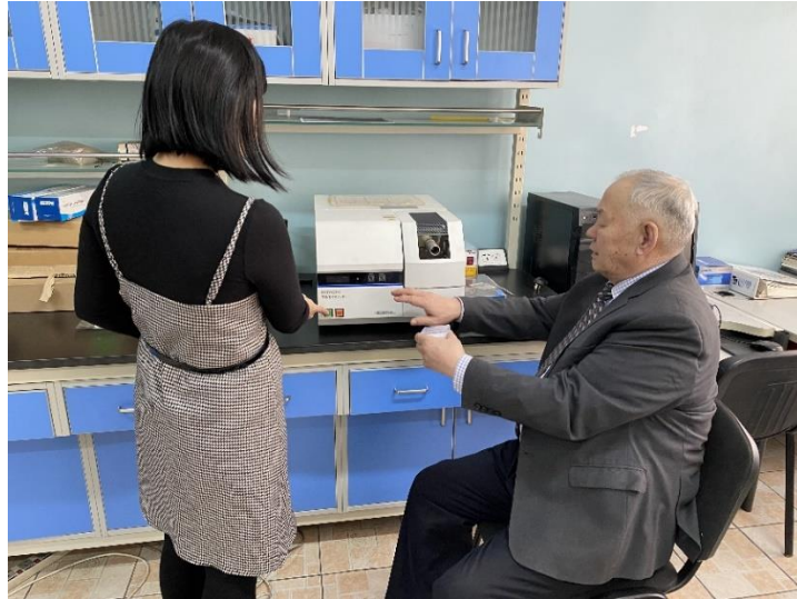
5.16 дугаар зураг. Хатуу түлшний задрах температурыг тодорхойлох байдал
