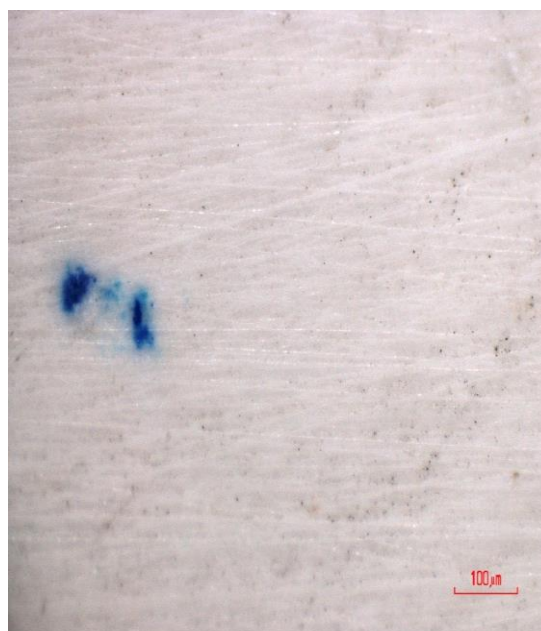
1.4-р зураг. Магнийн барьцалдагчтай сорьцыг бэхжүүлсэний дараа өнгөлгөө хийж түүний бүтцийн үүсэлтийг харахад нэг жигд нэг төрлийн эрдэс фаз байхаас гадна зарим урвалд бүрэн орж амжаагүй байх (зураг “а”) ба нэг жигд гадаргуутай болсон (зураг “б”) байна.
