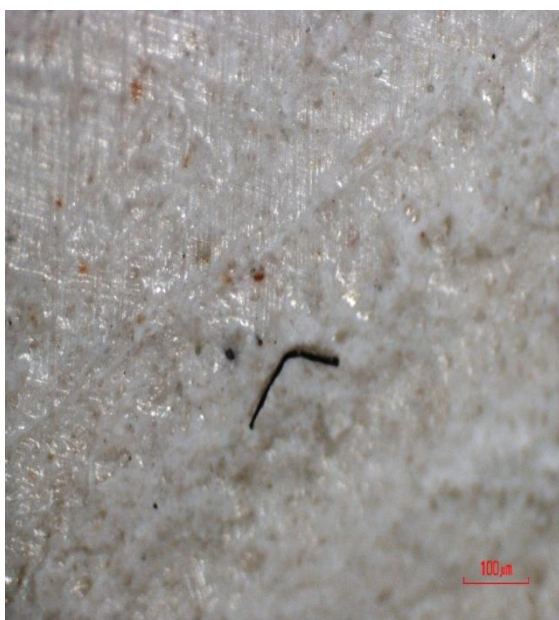
1.4-р зураг. Магнийн барьцалдагчтай сорьцыг бэхжүүлсэний дараа өнгөлгөө хийж түүний бүтцийн үүсэлтийг харахад нэг жигд нэг төрлийн эрдэс фаз байхаас гадна зарим урвалд бүрэн орж амжаагүй байх (зураг “а”) ба нэг жигд гадаргуутай болсон (зураг “б”) байна.
