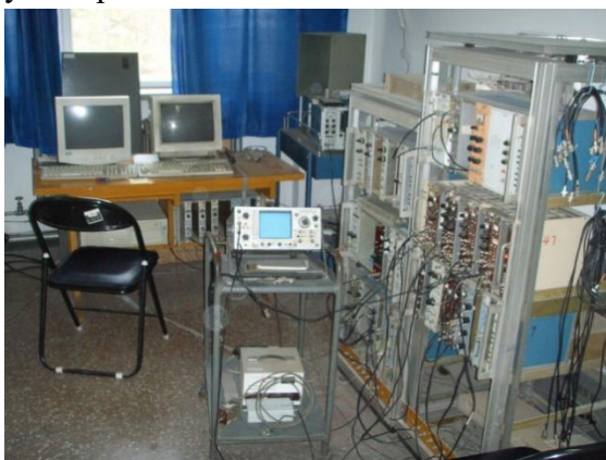
Зураг 4.5. Альфа-спектрометрийн электроникийн хэсэг
