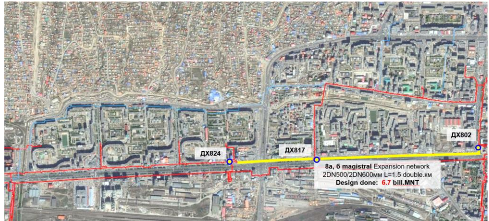
Зураг 6-3 ТК-802 - ТК-824. хоорондох хэсэг. Одоо байгаа шугам DN500. Төслийн дүнд шугам DN600 болж томорно. Хэсгийн урт нь 1.8 км байна.
