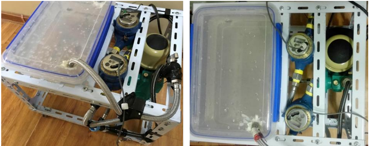
Зураг. 13. Усны тоолуурын автомат системийн туршилтын макет
