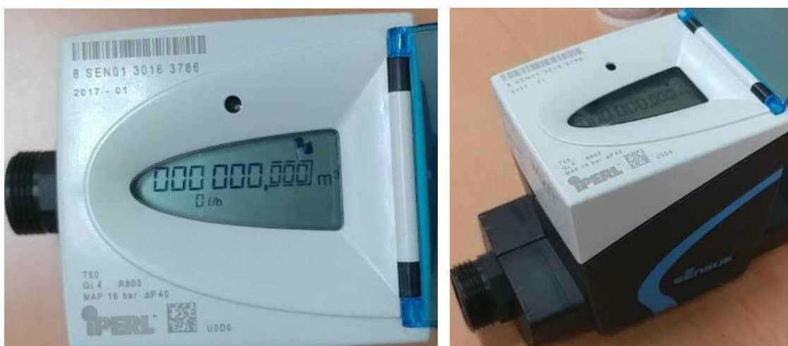
Зураг. 7. ХБНГУ-д улсад үйлдвэрлэсэн LoRa дамжуулагч бүхий усны электрон тоолуур
