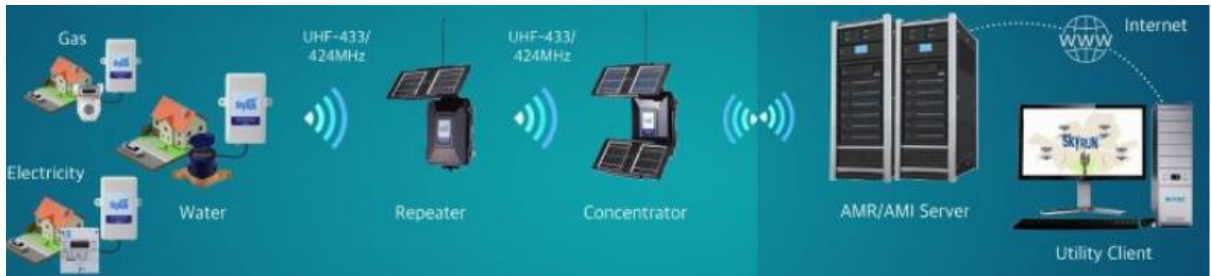
Зураг. 1. RF 424MHz давтамж ашиглан сүлжээ үүсгэсэн усны тоолуурын автомат системийн загвар
