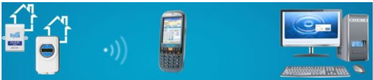
Зураг. 2. PDA ашиглан усны тоолуурын өгөгдлийг цуглуулах системийн бүтэц
