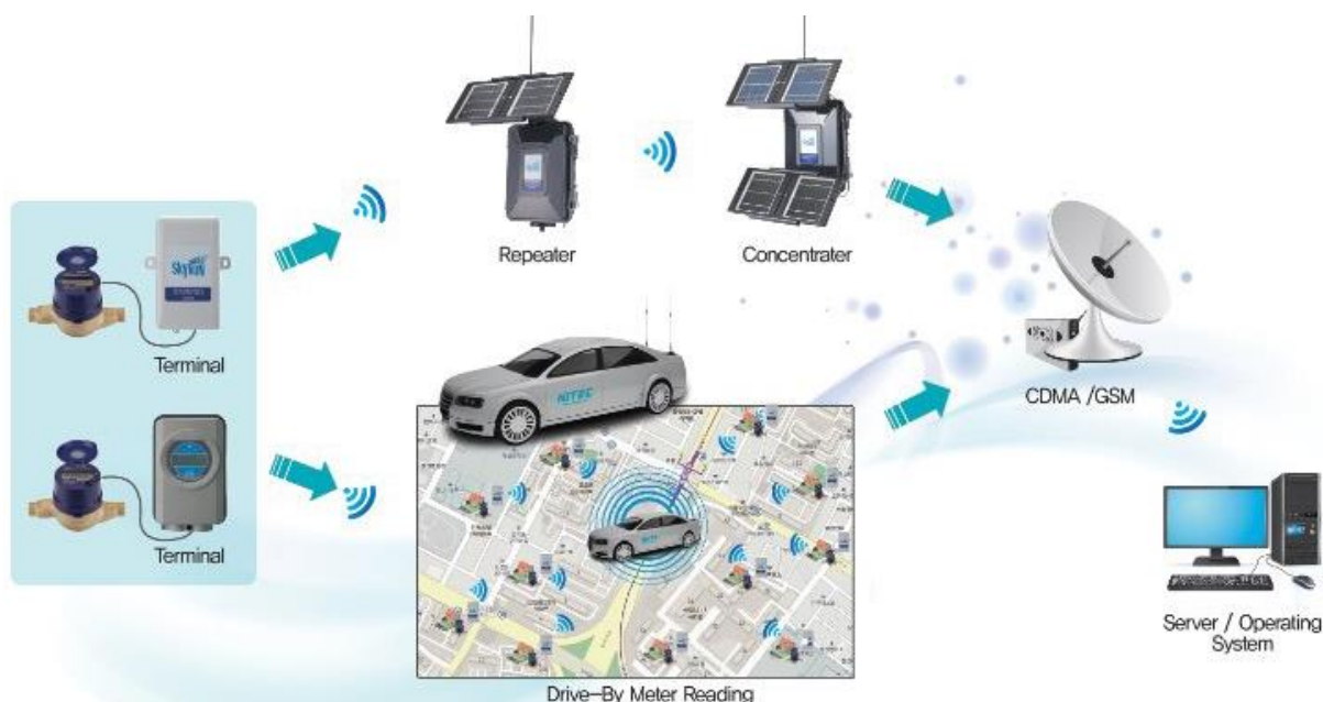
Зураг. 3. БНСУ-д ашиглаж байгаа усны тоолуурын өгөгдлийг цуглуулах системийн бүтэц
