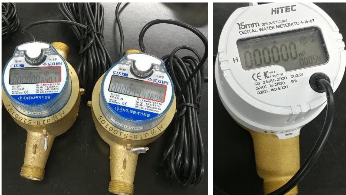
Зураг. 6. MR мэдрүүр ашигласан БНСУ-д үйлдвэрлэсэн усны электрон тоолуур
