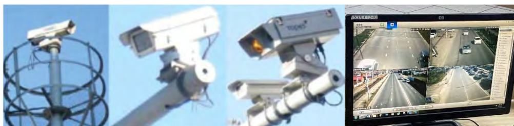
Эх сурвалж: Нийслэлийн замын хөдөлгөөний удирдлагын төв Зам, уулзвар дээр суурилуулсан хяналтын камер, LPR камер
