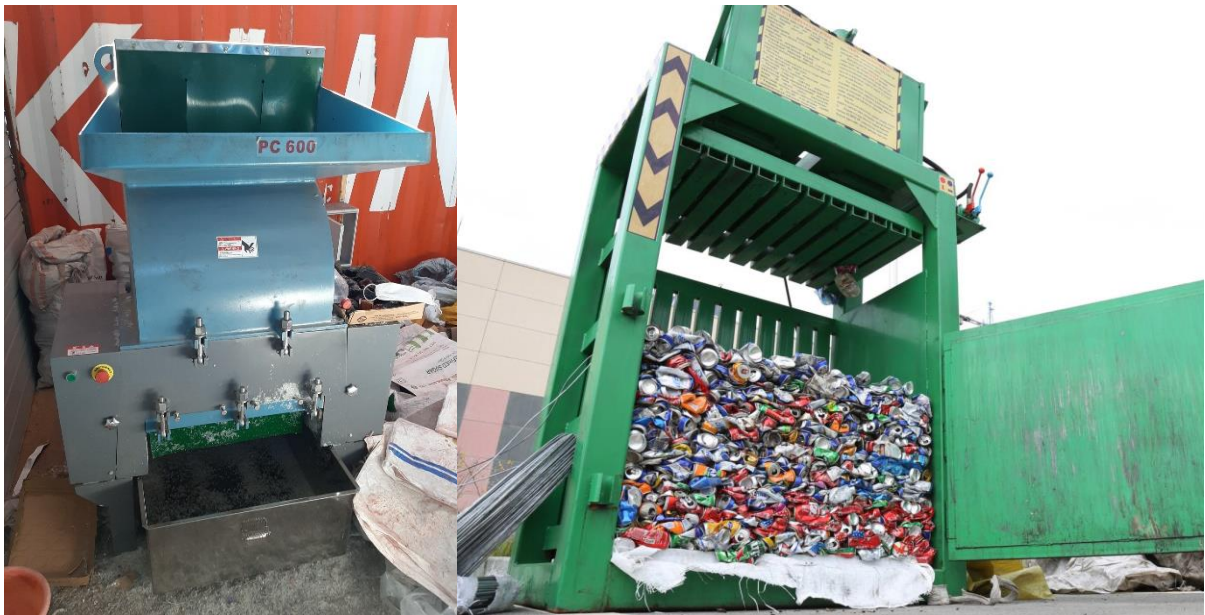
Зураг 32. Увс аймагт хүлээлгэн өгсөн дахивар хаягдал бутлах, пресслэх төхөөрөмж
