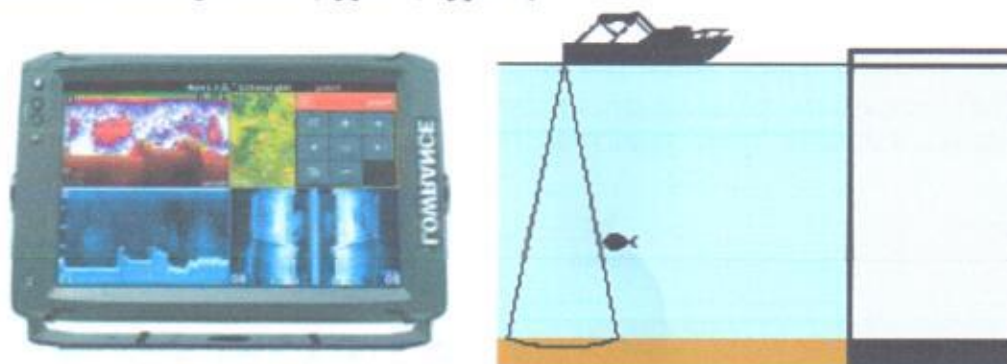
Зураг 3. Lowrance elite ti 12 багаж, ажиллах зарчим
