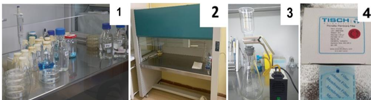
Зураг 10. 1- Шинжилгээнд авсан дээж болон туслах материал 2- Шинжилгээ хийгдсэн үндсэн хэсэг, 3- Ялтаст шүүлтүүрийн багаж, 4- Ялтаст шүүр
