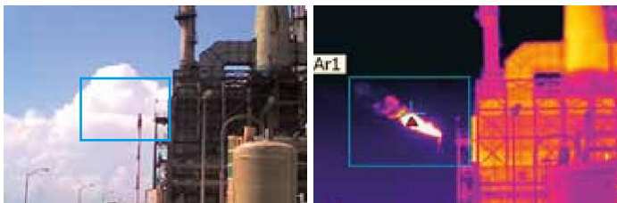
Нүдэнд үл үзэгдэх шаталтын дулааны зураглалал
