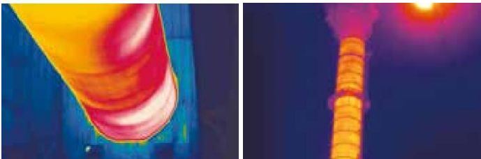
Зуух, реакторын галд тэсвэртэй хийц хэсгийн дулаан алдагдал
