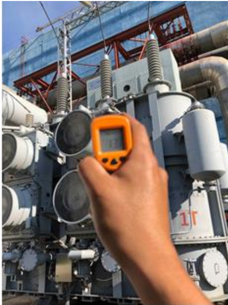
Зураг дээрх хэмжилтийн хэмжих зайн харьцаа алдагдсан D:S = 100:1 ихэнхи харьцаа 12:1 , 20:1 , 50:1 байдаг. Хэмжилтийн өнцөг 34^\circ буюу мэдрэмж 30\% орчим байна.
