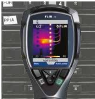
Дулааны камераар нэг дор 3600 цэгийг хэмжих байдал
