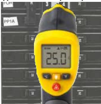
Цэгэн термометрээр 1 цэгийг хэмжих байдал
