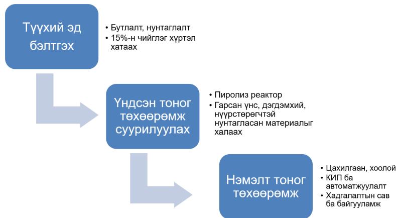
Зураг 43 Хэрэглээний дизель түлш үйлдвэрлэх технологи
